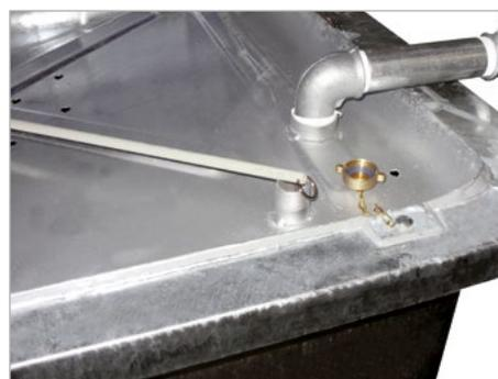
Peilstab zur Füllstandskontrolle
