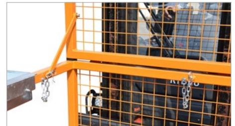
Sicherungen der abklappbaren Schutzgitter
